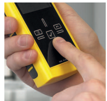
T610 en T660 hebben een doorlopend oppervlak van zeer krasbestendig Blanview-speciaalglas met capacitief touch-bedieningspaneel.
