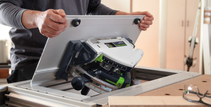
1 Compact Module Systeem: De mobiele invalcirkelzaag wordt een stationaire tafelcirkelzaag.
