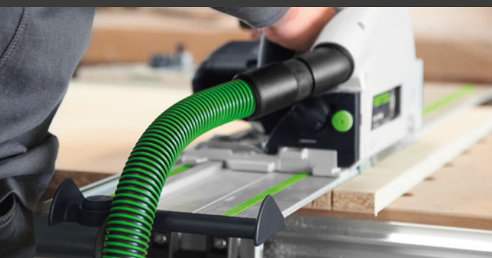
4 Slangbeschermer: voorkomt het blijven steken van de stofslang achter de geleiderail.
