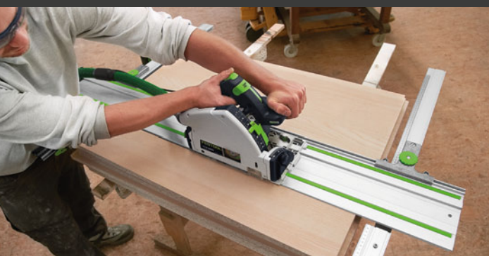
5 Parallelaanslag: Ideaal voor zaagsnedes in kleine series met een gelijke maatvoering.
