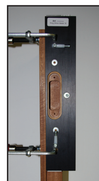
afb. 6 - Mal in kozijn
