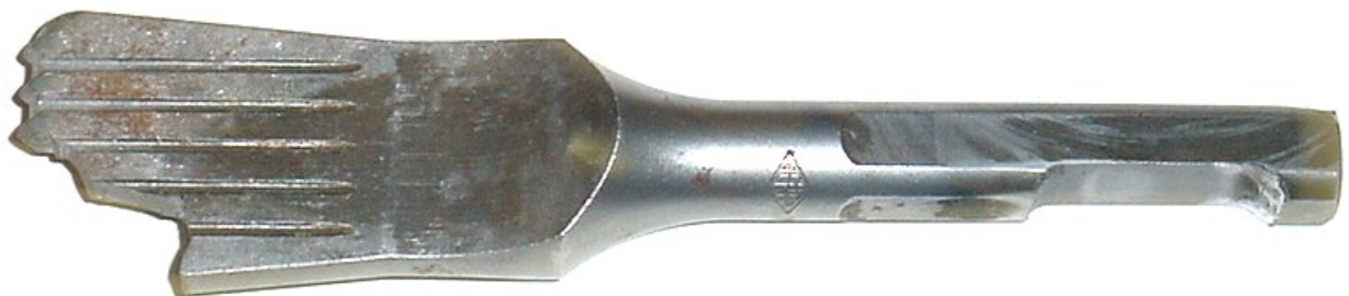
Beitelbladbreuk door slag tegen hard voorwerp in de gevel
